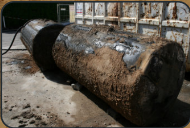
Bild 2: Undichte Tanks können dafür sorgen, dass z. B. Öl oder Lösemittel austreten und Boden und Grundwasser verunreinigen.
