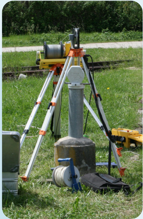
Bild 8: Durchführung eines Flowmetertests in einer Messstelle. Mit dem Lichtlot (im Vordergrund) kann der Grundwasserstand bestimmt werden.
