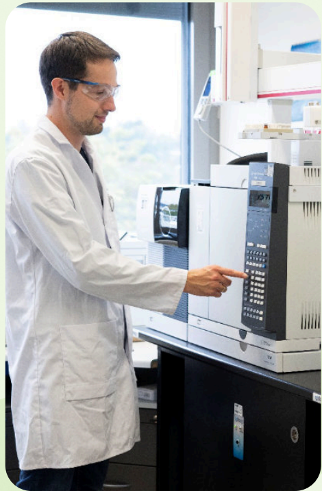
Bild 14: Mit einem Gaschromatographen können die Inhaltsstoffe von zuvor präparierten Proben sehr genau bestimmt werden.
